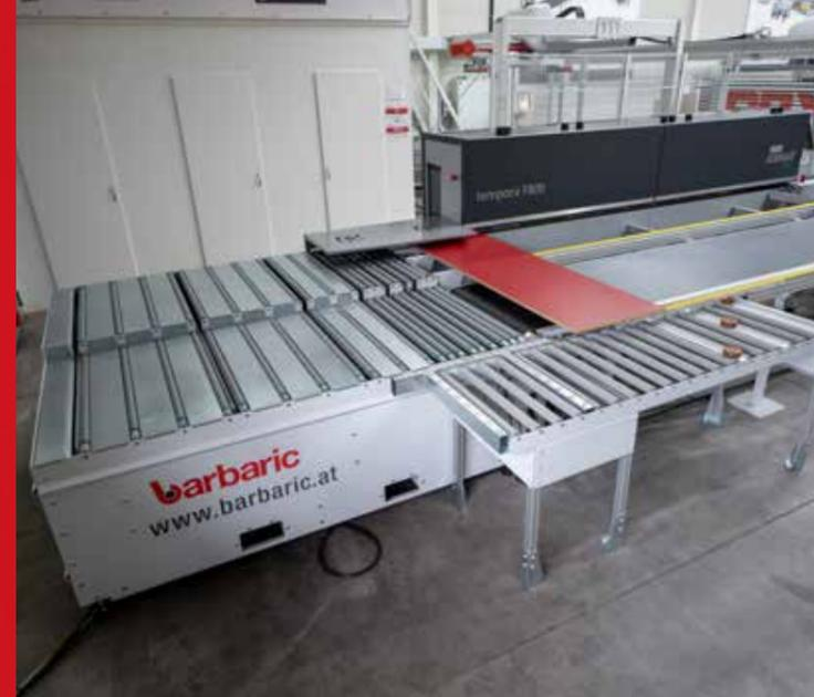
Einfache Anbindung an die Kantenanleimmaschine
