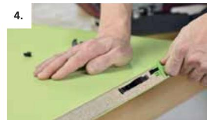
4. Vorspann-Clip eindrücken zum einfacheren Zusammenfügen der Bauteile.
